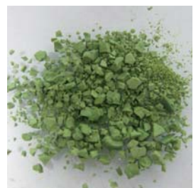
Farbstoffmoleküle sollen ermöglichen, dass Titandioxid bereits durch sichtbares Licht als Katalysator aktiv wird. (Quelle: Uni Kassel)
