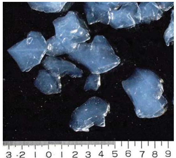
Aerogel ist durch die geringe Größe der zahlreichen mit Luft gefüllten Kammern neben Vakuum das beste Isolationsmaterial. (Quelle: Cabot Nanogel)
