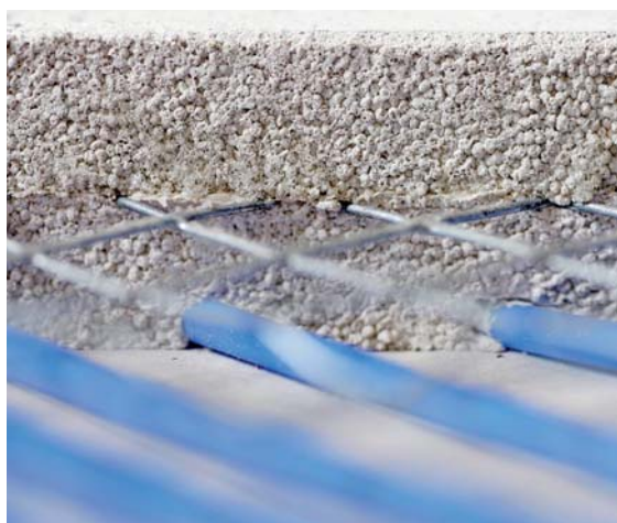
Phasenwechselmaterialien sorgen in Bauwerkstoffen für eine natürliche Klimatisierung von Innenräumen. (Quelle: BASF)
