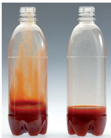
Nanotechnologisch optimierte Verpackungen präsentieren Lebensmittel beispielsweise durch Nutzung des Antibeschlag-effektes attraktiver (rechts). Durch Antihaft- und Gasbarrierschichten (links) können eine verbesserte Restentleerung und geringeres Verpackungsgewicht erzielt werden und so dem Verbraucher die Handhabung des Produktes erleichtern und zudem auch ökologische Vorteile bieten. (Quellen: Duni; Fraunhofer IVV)
