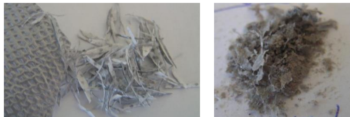
Abbildung 8: Einwegprodukt mit nanosilberhaltigen Fluorcarbon-Beschichtung auf Vlies-Folien-Laminat -links- vor der Probenvorbereitung -zentral- nach Grobzerkleinerung -rechts- nach der Probenvorbereitung.
