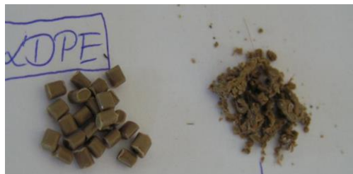
Abbildung 4: LDPE-Masterbatch (aus AP 3.1) -links- vor der Probenvorbereitung -rechts- nach der Probenvorbereitung: Der Kunststoff konnte durch Schmelzen zerkleinert werden. Die Größe der erhaltenen Kunststoffteilchen beträgt ca. 0,5 - 2mm.
