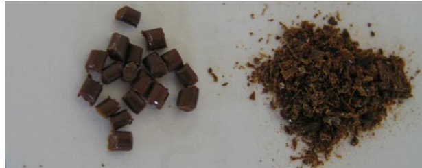
Abbildung 3: Polyamid (PA)-Masterbatch (aus AP 3.1) -links- vor der Probenvorbereitung -rechts- nach der Probenvorbereitung.
