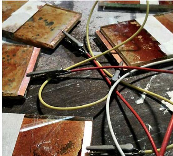
Versuch zur Integration der Prinzipien von farbstoffsensitiven Solarzellen in Betonwerkstoffe (Foto: Negar Jahadi Rafigh)
