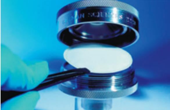
Kompositmembran mit selektiven Nanopartikeln für die Wasserreinigung
