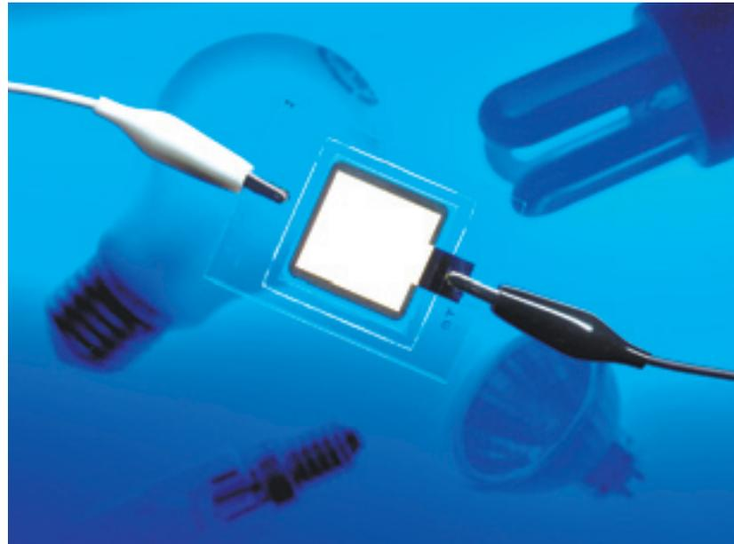
Beleuchtungselement mit flacher organischer Leuchtdiode (OLED)
