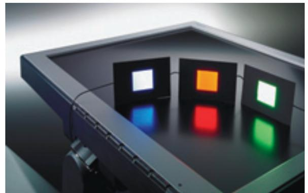
Farbige OLEDs für Display- und Beleuchtungsanwendungen
