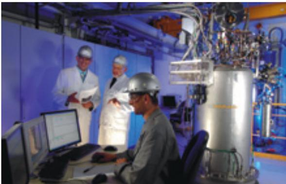
Reaktor zur Herstellung von CNTs
