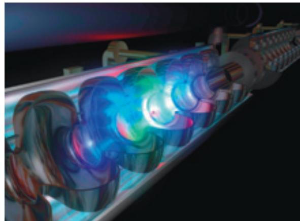
Supraleitende Resonatoren zur Elektronenbeschleunigung in einem Freie-Elektronen-Laser (XFEL)
