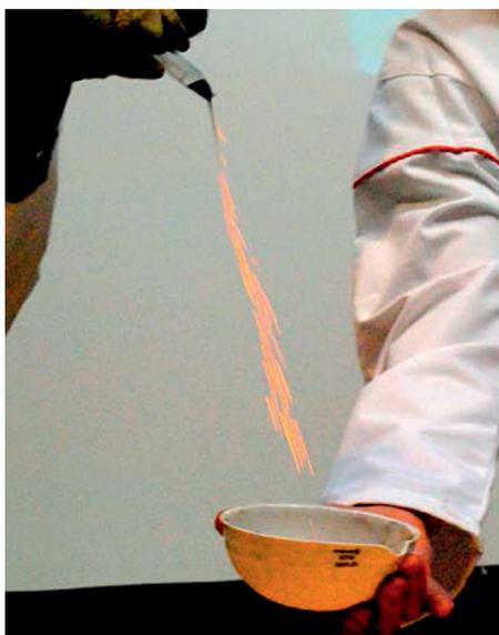
**Abb. 5:** Eisen-Nanopartikel unter Schutzgas in einem Glasgefäß werden langsam ausgeschüttet. Bereits nach wenigen Zentimetern verglühen die Nanopartikel an der Luft, indem sie mit dem Luftsauerstoff reagieren (Bildquelle: Empa).
