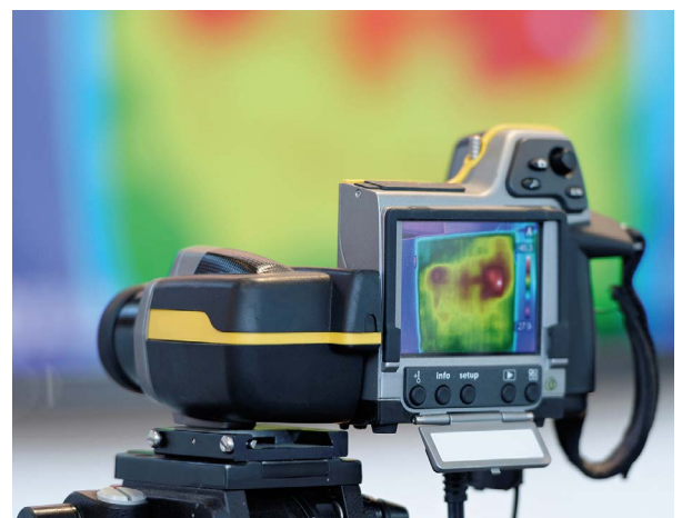
Thermografie zur zerstörungsfreien Werkstoffprüfung
