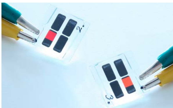
Nanokristalle aus Silizium ermöglichen die Herstellung Siliziumbasierter Leuchtdioden: Durch Änderung der Größe der Silizium-Nanokristalle lässt sich die Farbe des ausgesandten Lichts variieren. (Quelle: F. Maier-Flaig, KIT/LTI).
