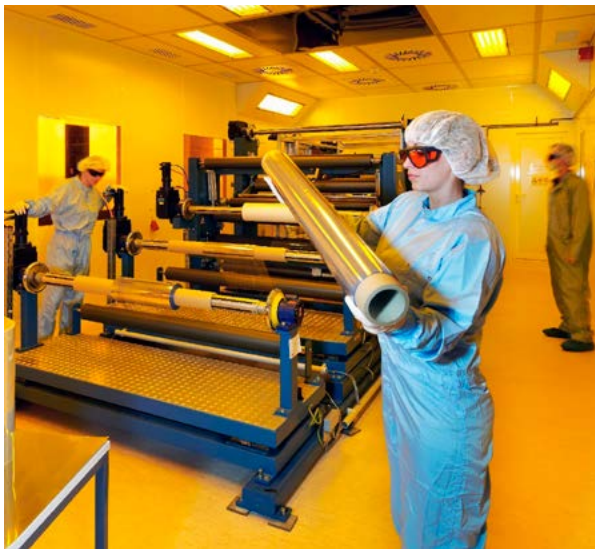
Herstellung nanoskaliger Schichten im Pilotmassstab (Quelle: INM, Uwe Bellhäuser, das bilderwerk).
