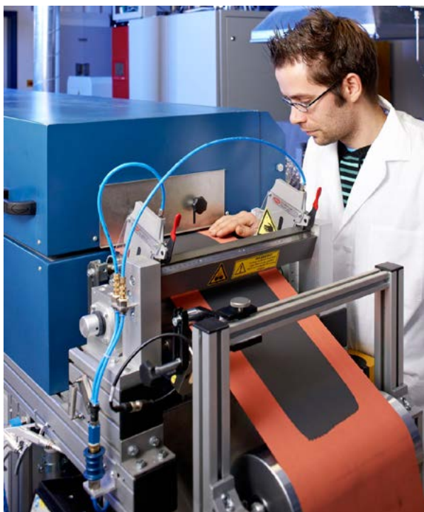
Beschichtung der Elektroden von Lithium-Schwefel-Batterien im Rolle-zu-Rolle-Verfahren. (Quelle: Jürgen Jeibmann/Fraunhofer IWS).
