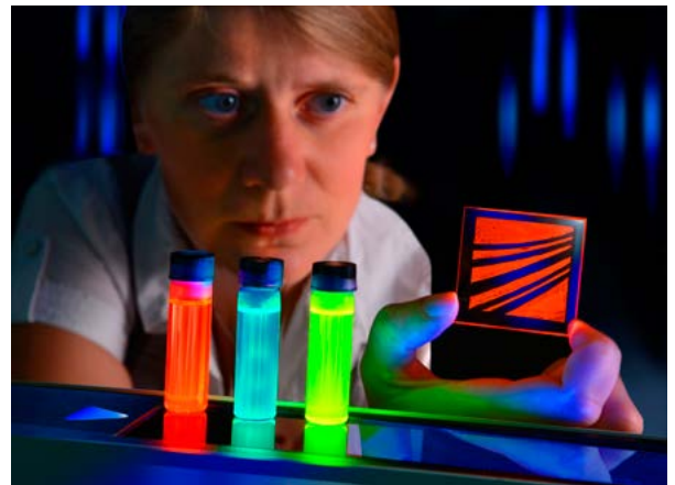
Im vom BMBF geförderten Kompetenznetzwerk für Nanosystemintegration „nanett“ werden empfindliche optische Sensoren entwickelt, die anzeigen können, welche mechanischen Belastungen auf Materialien wirken. Das Bild zeigt einen Probekörper, der mit winzigen, d.h. nanometer-großen Halbleiter-Partikeln beschichtet ist. Wenn die winzigen Halbleiter-Partikel mit UV-Licht angeregt werden, beginnen sie zu fluoreszieren. Welche Farbe das ausgesendete Licht hat, hängt von der Größe der Partikel ab. Wirkt an manchen Stellen eine mechanische Spannung auf das Material, stoppt diese Fluoreszenz. (Quelle: Fraunhofer ENAS, Foto Hr. Thieme).
