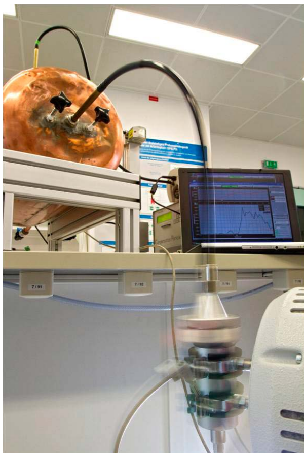
Prüfstand der BAuA zur Ermittlung des Staubungsverhaltens von Nanomaterialien (Shakerverfahren) (Bild: BAuA/Fox).
