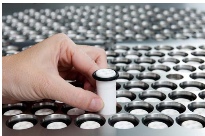
Keramische Nanofiltrationsmembranen (links in elektronenmikroskopischer Aufnahme) werden zur effektiven und umweltschonenden Abwasserreinigung und Produkttrennung eingesetzt (Quelle: Fraunhofer IKTS).
