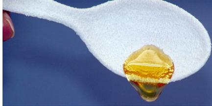
Nanotechnologie für den Hausgebrauch: Dank Lotus-Effekt läuft Honig von diesem speziell beschichteten Löffel vollständig ab. Foto: dpa
