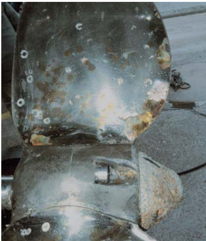
Abbildung 6 Ein teilbeschichteter Sportbootpropeller vor (oben) und nach der Auslagerung in der Nordsee 2008. Während die unbeschichtete Propellernase eine dicke Kruste aus Seepocken aufweist, zeigen die mit SILIKOPON® EF behandelten Propellerblätter nahezu keinen Bewuchs
