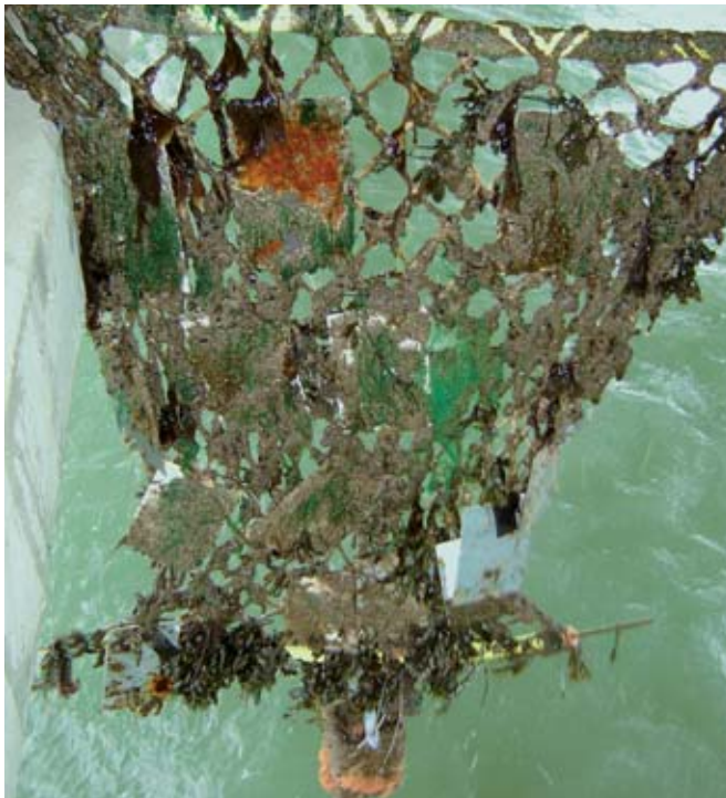
Abbildung 3 Testplatten mit unterschiedlichen siliconhaltigen Beschichtungen nach achtmonatiger Auslagerung in einem Fangnetz in der Nordsee
