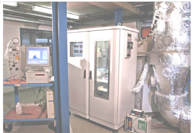
Abbildung 1. Das Karlsruher Expositionssystem im Schema und bei der Installation an der Technikanlage AEOLA zur reproduzierbaren Erzeugung von definiertem TiO 2 -Aerosol.
