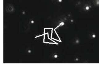
Abb. 1. Aufnahme einer \text{SiO}_2 -Suspension mit der Nanosight TM -Technik und exemplarisch eingezeichnetem Pfad eines Nanopartikels
