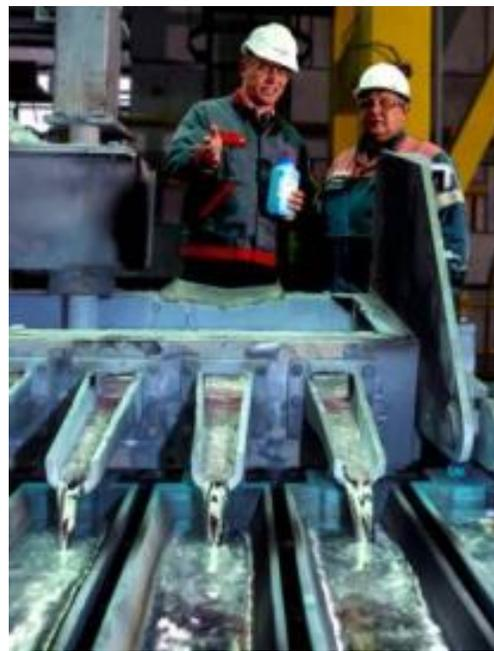
Einguss flüssiges Metall in mit Trennmittel beschichtete Kokille
