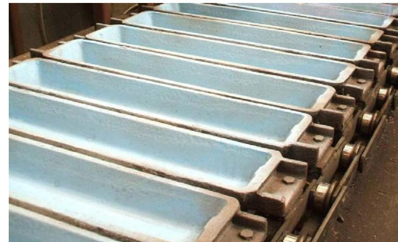
Mit Trennmittel (blau) beschichtete Kokille für den Al-Maseguss nach Entnahme Gussteil
