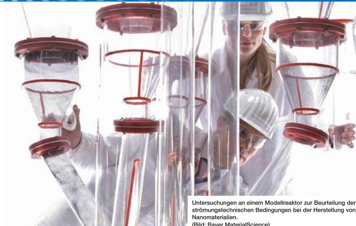
Untersuchungen an einem Modellreaktor zur Beurteilung der strömungstechnischen Bedingungen bei der Herstellung von Nanomaterialien.
