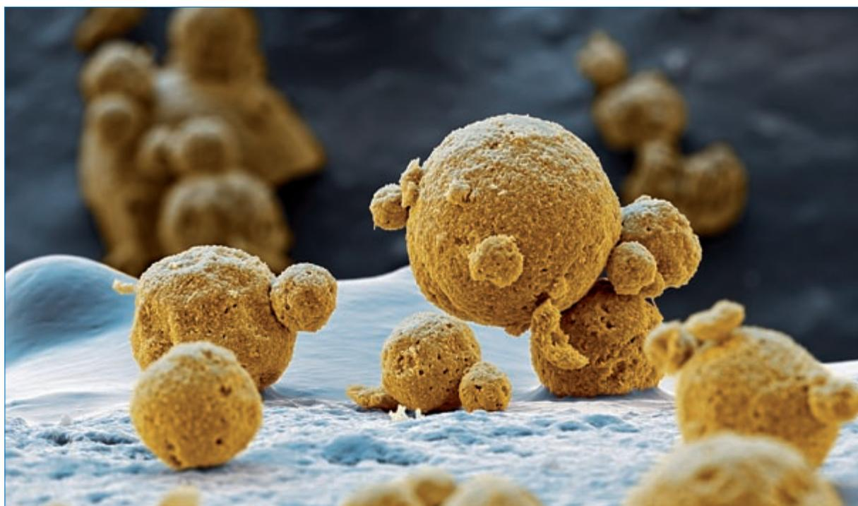
Elektronenmikroskopische Aufnahme von nano- bis mikrometeregroßen Metalloxid-Partikeln, die als Energiespeicher in Lithium-Ionen-Batterien eingesetzt werden. Die Lithium-Ionen sind in das Metalloxid eingeschlossen. Dadurch entsteht kein brennbares Lithium und die Batterien sind sicherer. (Bild: BASF)
