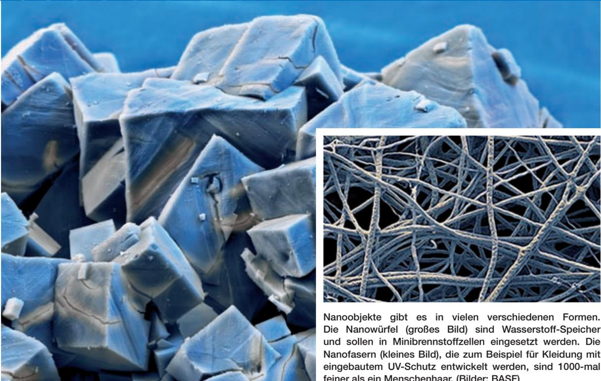
Nanoobjekte gibt es in vielen verschiedenen Formen. Die Nanowürfel (großes Bild) sind Wasserstoff-Speicher und sollen in Minibrennstoffzellen eingesetzt werden. Die Nanofasern (kleines Bild), die zum Beispiel für Kleidung mit eingebautem UV-Schutz entwickelt werden, sind 1000-mal feiner als ein Menschenhaar. (Bilder: BASF)
