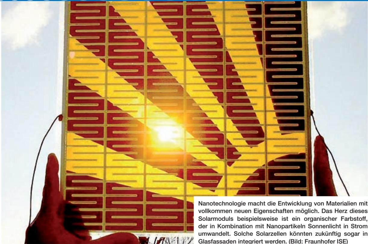
Nanotechnologie macht die Entwicklung von Materialien mit vollkommen neuen Eigenschaften möglich. Das Herz dieses Solarmoduls beispielsweise ist ein organischer Farbstoff, der in Kombination mit Nanopartikeln Sonnenlicht in Strom umwandelt. Solche Solarzellen könnten zukünftig sogar in Glasfassaden integriert werden. (Bild: Fraunhofer ISE)
